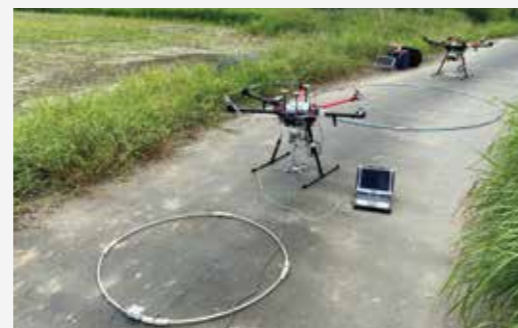
2機のUAVを使った空中電磁探査(実業務で世界初の試み!)
