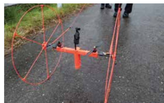
吊り下げ型ののり面点検装置
